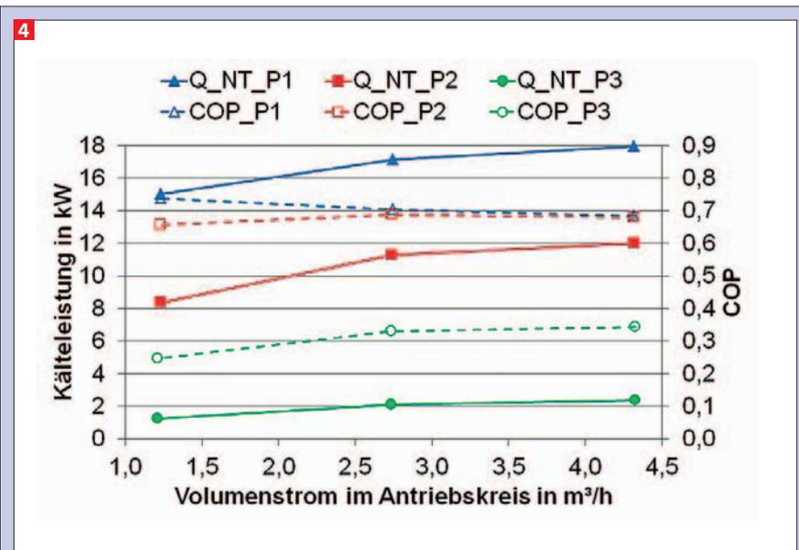
Kälteleistung und COP über dem Antriebskreisvolumenstrom an drei Betriebspunkten P1 (88/31/12,5), P2 (79/32/12,5), P3 (70/33/12,5)
