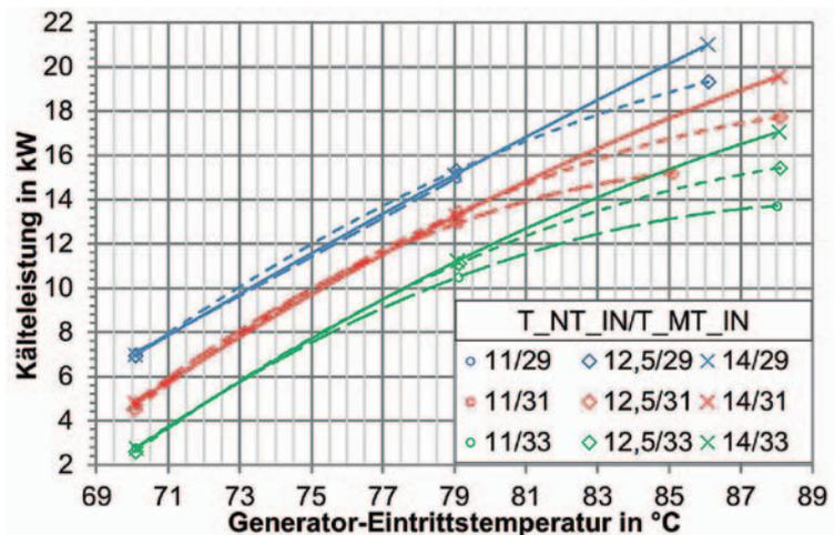
Kälteleistung über der Generator-Eintrittstemperatur bei verschiedenen Kältekreis- und Rückkühlkreis-Eintrittstemperaturen (T<sub>NT\_IN</sub>, T<sub>MT\_IN</sub>)
