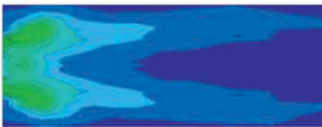
(Abb. 5) Luftverteilung beim AxiCool ohne Strömungsgleichrichter (links) und die optimierte mit Luftverteilung mit Strömungsgleichrichter, mit dem sich die Wurfweite verdoppeln lässt (rechts).
