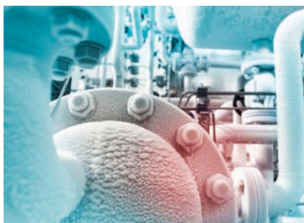
Der Einsatz von Flüssigstickstoff als Kältemittel ermöglicht Temperaturen von -196\text{ }^{\circ}\text{C} . Damit werden die gewünschten -80\text{ }^{\circ}\text{C} schnell erreicht.
