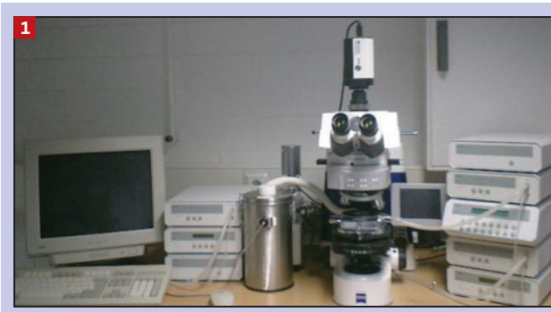
1 Modernes Video-Kryomikroskopie-System mit diversen Frierkammern der Firma ZEISS (Axio Imager) und Firma LINKAM (FDSC196, BS196, GS350).
