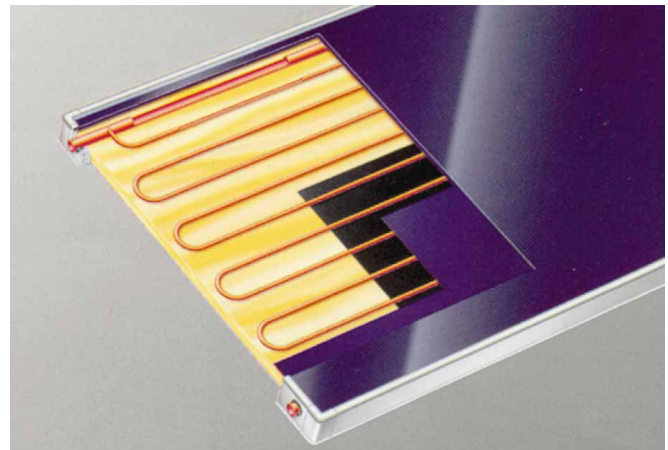
Bild 6: Seriell durchströmter Flachkollektor (Viessmann, Vitosol 100 s2,5) [6]
